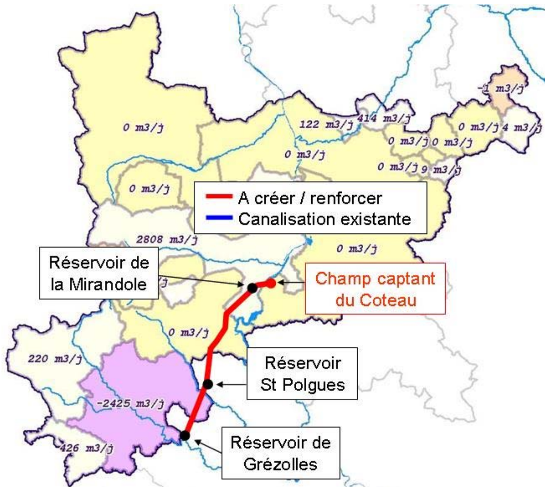
Figure 4-6 : Principe des aménagements du secours du SIE de la Bombarde par de l'eau traitée du champ captant du Coteau
