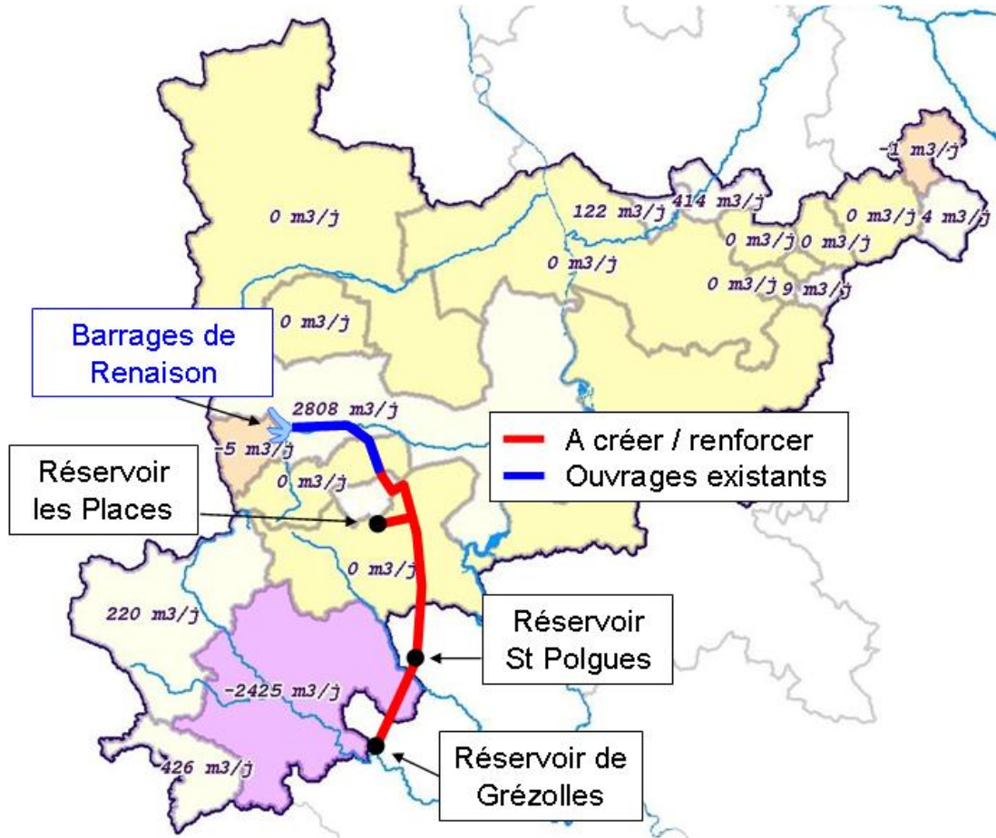
Figure 4-5 : Principe des aménagements du secours du SIE de la Bombarde par de l'eau traitée des barrages de Renaison
